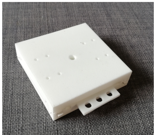
Figur 14: 3D-printade testtrigg. Magneter och bakplatta är fästa i statonära delar medans spolen sitter fäst i en spolvagn som rör sig mot infästa kuler.
